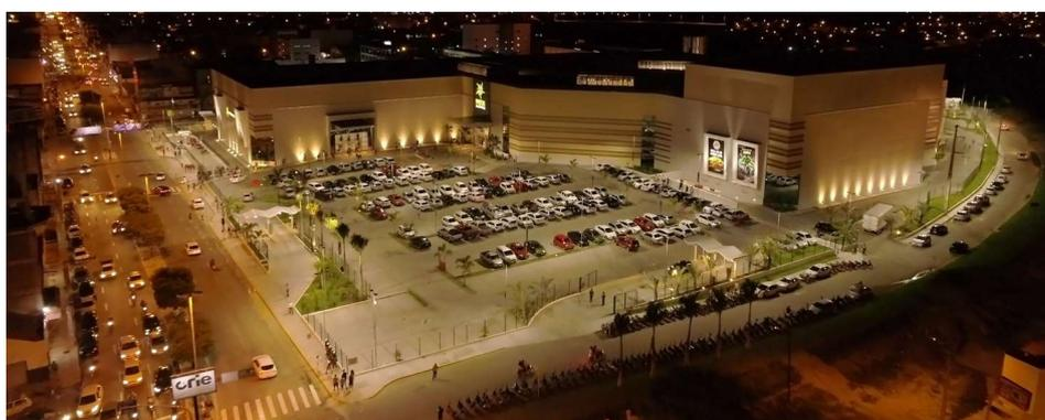
Acima, estacionamento coberto com perfis de LED de 38W a 4000K para atingir 150 lux. Ao lado, embutidos de solo de 52,6W/10° a 3000K destacam as paredes da fachada, enquanto luminárias para iluminação pública de 88W a 5000K em postes de oito metros de altura iluminam os acessos de veículos e estacionamento descoberto.
